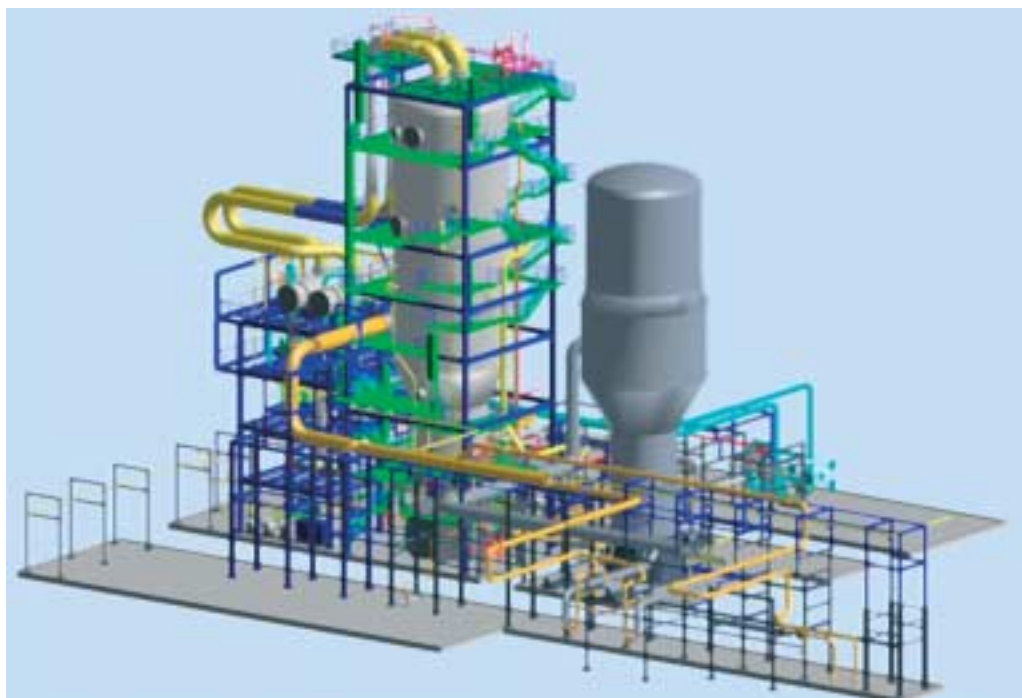
Die neue Vakuumkolonne der MiRO in Karlsruhe weist mit 8,3 m Durchmesser und 32 m Höhe ein Gewicht von 230 t auf.
