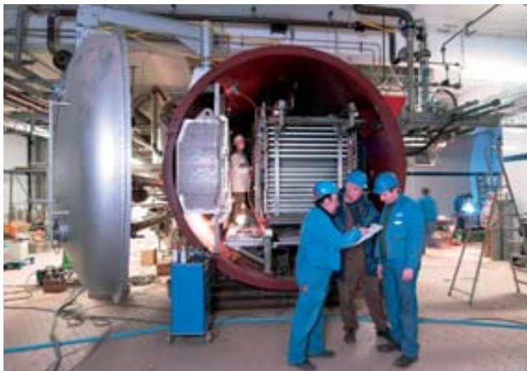
Abb. 1 Bei der neuen Gefriertrocknungsanlage sind die Verfahrensabläufe so konzipiert, dass ein kontinuierlicher Trocknungsprozess ablaufen kann
